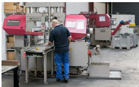
Scies pour découpes de barres rondes sur 6 m de long, jusqu'à un diamètre de 450 mm Bar saws for round bars from 6 m long, up to 450 mm
