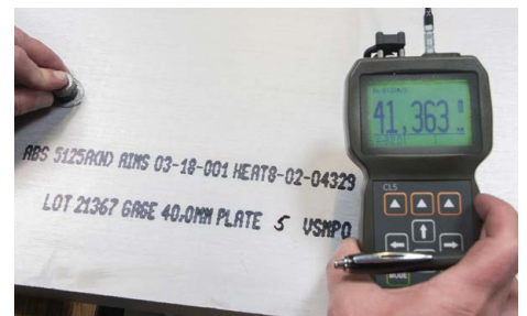
Contrôle à l'entrée avec appareil de mesure à ultrasons Incoming inspection with the ultrasonic measuring instrument
