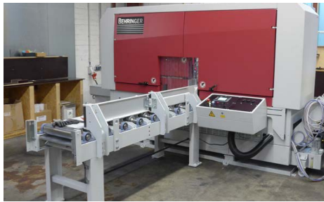
Scie à ruban haute performance avec une énorme capacité de coupe High performance band saw with enormous cutting capacity
