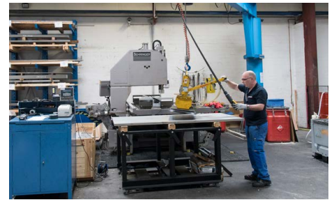
Ponts pour alimentation des scies Crane feeding to saw
