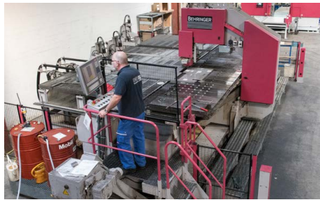
Scie à ruban pour plaques épaisses jusqu'à 2 x 6 m à tête mobile Plate saw up to 2 x 6 m with movable cutting head
