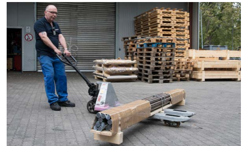
Hochwertige Verpackung mit Holzklötzen ermöglicht den Transport mit Stapler und Hubwagen High quality packaging with wooden blocks enables transport with forklift and pallet truck
