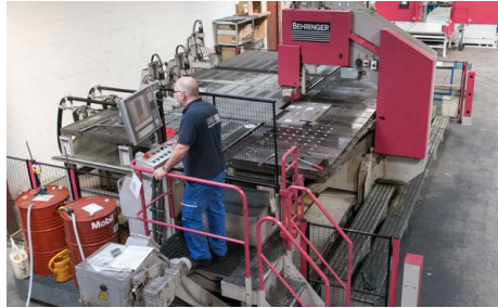
Plattensäge bis 2 x 6 m mit beweglichem Schneidkopf Plate saw up to 2 x 6 m with movable cutting head
