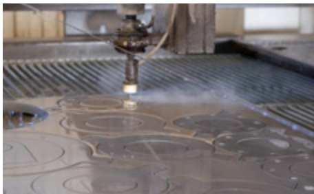
Découpe jet d'eau Materials blanks using water jet technology
