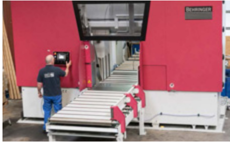
Scie à ruban haute performance jusqu'à 1 m de diamètre, Tôles épaisses et Barres rondes High performance band saw up to 1 m flat and round
