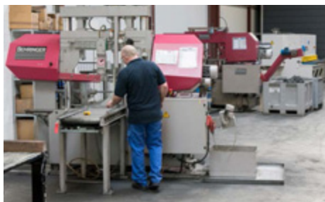
Scies pour découpes de barres rondes sur 6 m de long, jusqu'à un diamètre de 450 mm Bar saws for round bars from 6 m long, up to 450 mm diameter
