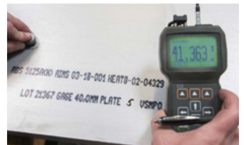
Eingangsprüfung mit dem Ultraschallmessgerät Incoming inspection with the ultrasonic measuring instrument
