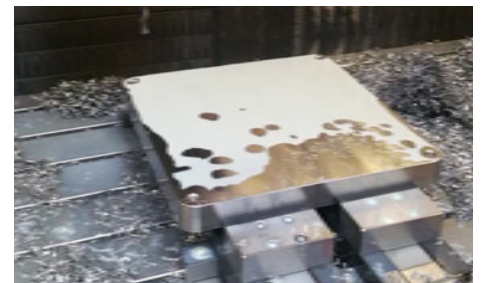
Bauteilfertigung nach Kundenzeichnung Build platforms according to customer drawings
